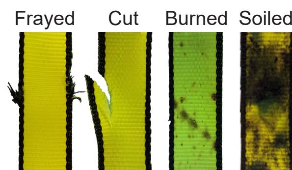
Fig. A: Webbing Defects
